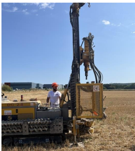
Figure 10 : Sondages réalisés à la tarière mécanique
