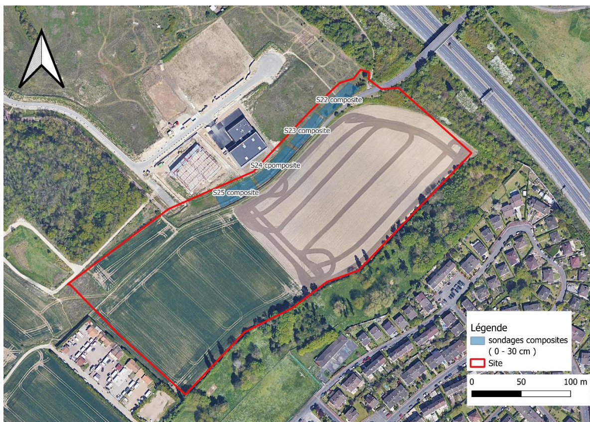
Figure 12 : Sondages réalisés à la tarière manuelle
