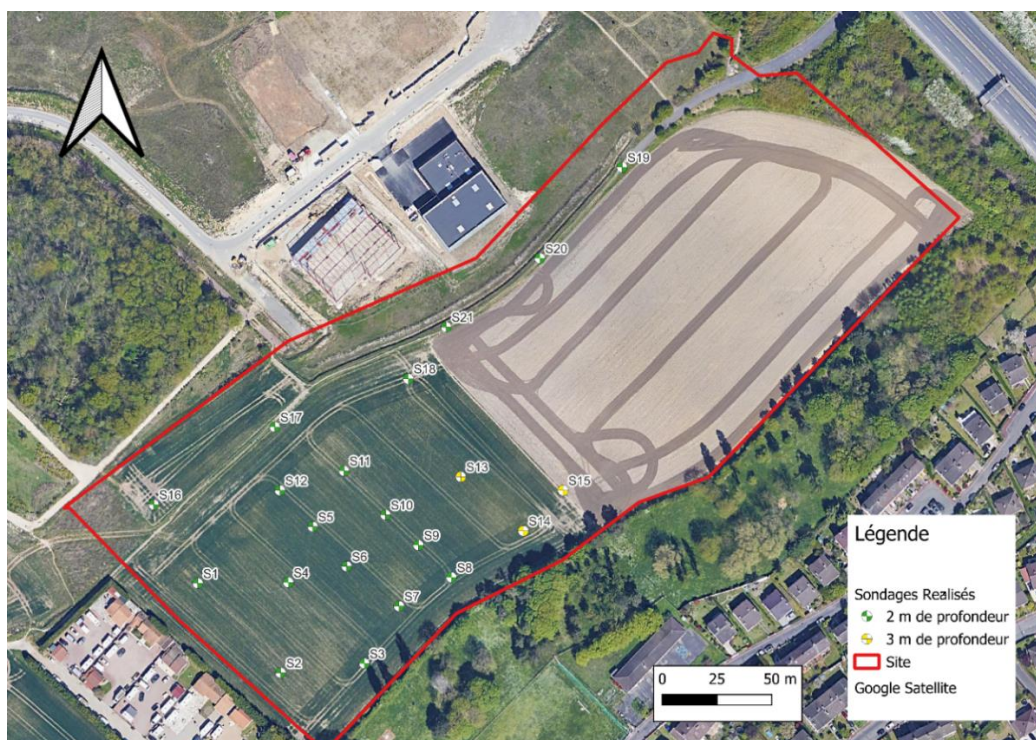
Figure 10 : Sondages réalisés à la tarière mécanique
