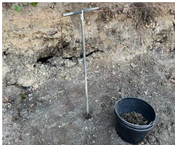
Figure 12 : Sondages réalisés à la tarière manuelle
